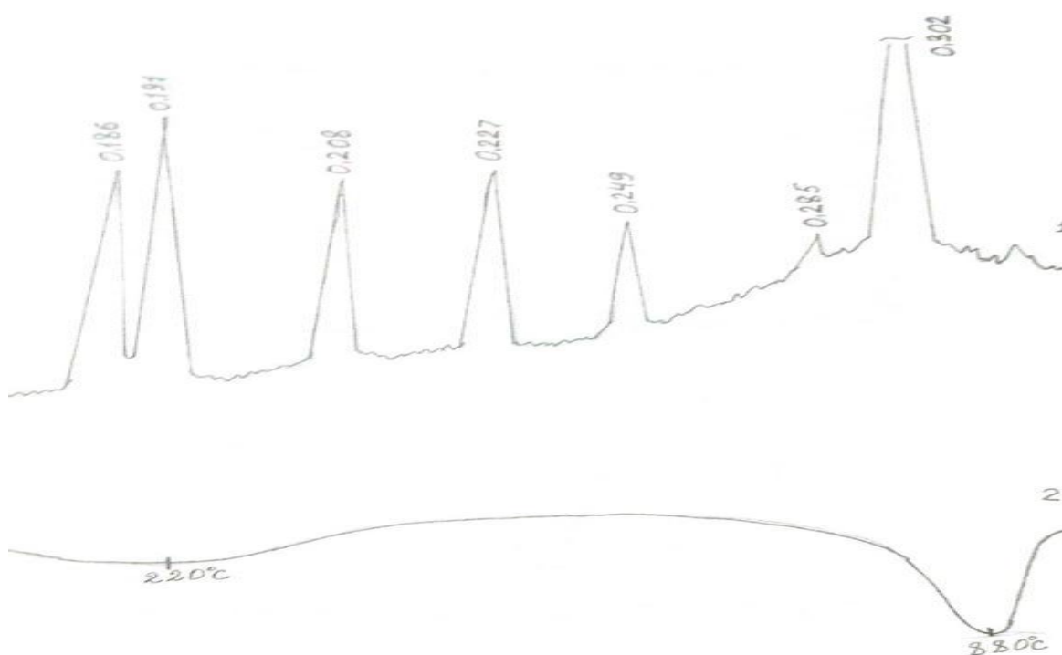
Рис 1. Рентгенограмма (1) и термограмма (2) мраморной муки Нукусского мраморного завода
